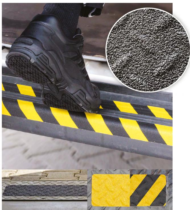
Гибкая алюминиевая подложка принимает форму неровной поверхности. Основа из ПВХ, противоскользящее покрытие с зерном из оксида алюминия, самоклеящаяся сторона с защитной лентой для защиты клеевого слоя, акриловый клеевой слой, толщина без защитной плёнки менее 1 мм.
