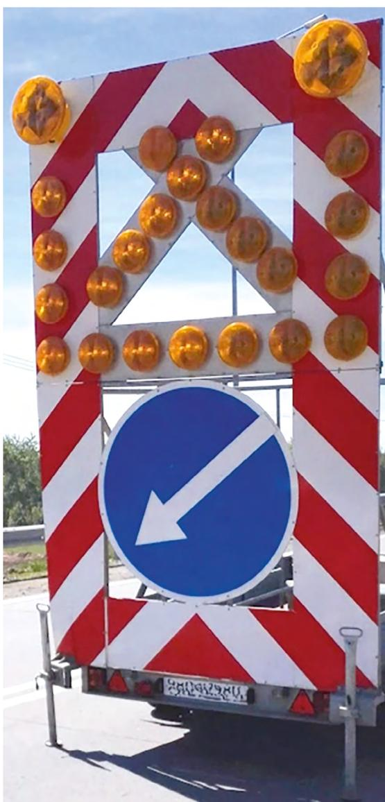
Передвижной заградительный щит представляет собой стойку с знаками, может устанавливаться на борт специальных автомобилей или на дорожное полотно. Стойка дополняется светодиодными знаками и стробоскопами. Заградительный знак со световой индикацией применяется в местах проведения дорожно-строительных или ремонтных работ, для оповещения водителей о необходимости объезда. Каркас изготавливается из окрашенного металлического профиля, обладает высокой прочностью.
