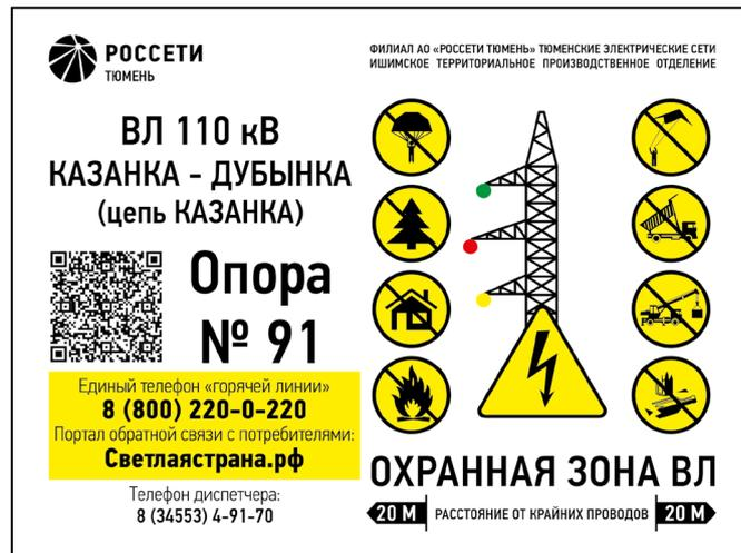
Плакат выполняется из металла (серебристый или белый). Формат: для ПС 35 кВ и выше – 900 × 600 мм (возможно пропорциональное изменение формата), для ТП/РП — 400 × 300 мм.
